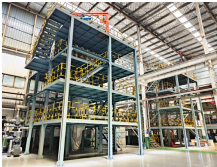
增材制造用高性能金属粉末真空气雾化装备
