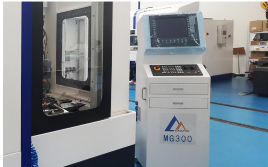
海西分院研发的超精密自由曲面复合加工机床具有精密车削高效率的特点，可同时实现纳米精度和极低表面损伤的高端制造技术，用于有色金属等材料超精密切削加工，能够适应各种加工需求。该设备在航空航天、光学及民用等领域的应用十分广泛。
